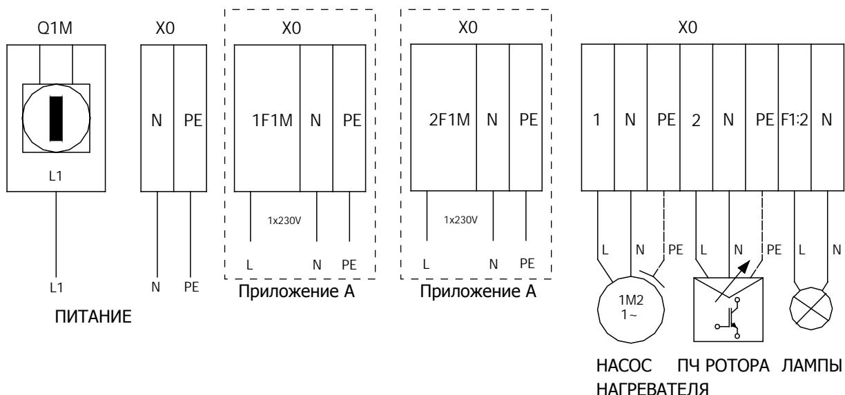
**Приложение 7 Принципиальная схема подключения питания и электродвигателя вентилятора для щитов управления VS 40-150 CG UPC SUP**
