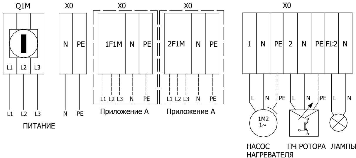
**Приложение 9 Принципиальная схема подключения питания и электродвигателя вентилятора для щитов управления VS 180-300 CG UPC (используется также для приточных систем VS 400-650)**
