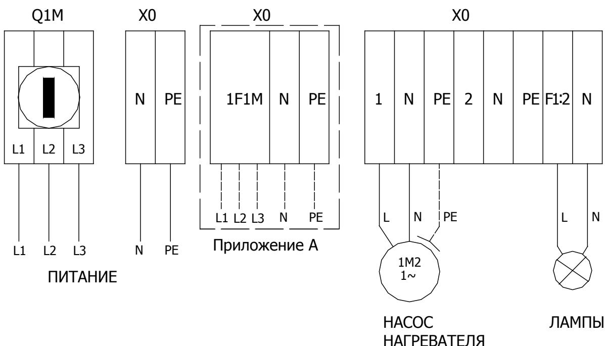
**Приложение 8 Принципиальная схема подключения питания и электродвигателя вентилятора для щитов управления VS 40-150 CG UPC SUP-EXH (используется также для приточных систем VS 180-300)**
